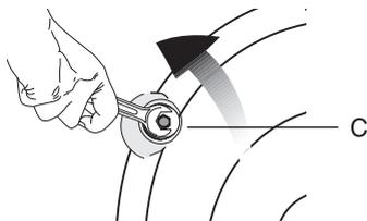
2. Снимите предохранительные транспортировочные болты, осторожно поворачивая их.
