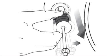
3. Установите заглушки (находятся в пакете вместе с Руководством по эксплуатации) в отверстия на задней стенке. («Р»)
